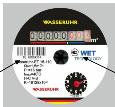
Рисунок 3 – Место нанесения знака утверждения типа и заводского номера
