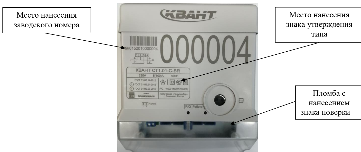
Рисунок 2 – Общий вид счетчика в корпусе типа С с указанием места ограничения доступа к местам настройки (регулировки), места нанесения знака утверждения типа, места нанесения заводского номера
