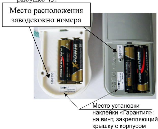
Рисунок 43 – Схема пломбировки от несанкционированного доступа. Место расположение заводского номера
