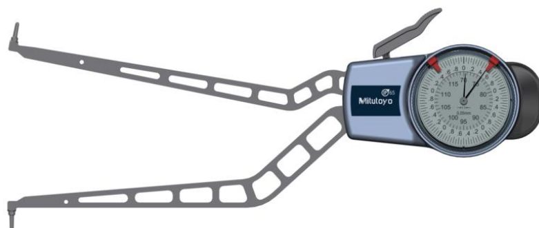
Рисунок 1 – Общий вид кронциркулей 209 для внутренних измерений с отсчетом по круговой шкале (окончание)
