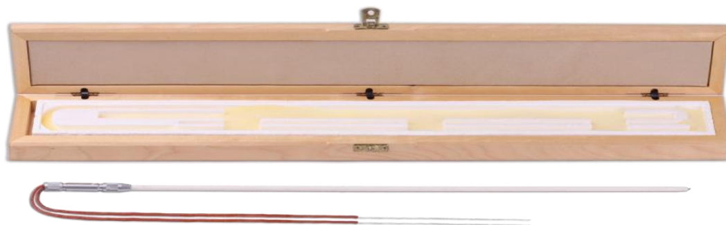
Рисунок 1- Общий вид преобразователя термоэлектрического платинородий-платинородиевого ПРО 0-го разряда
