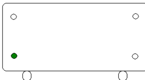
Рисунок 2 – Схема пломбировки от несанкционированного доступа Знак поверки наносится на свидетельство о поверке.
