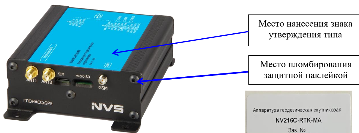
Рисунок 4 - Общий вид аппаратуры геодезической спутниковой NV216C-RTK-MA
