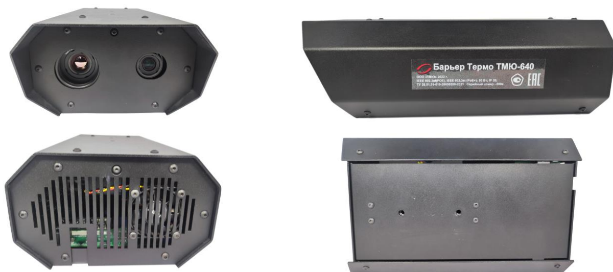
Рисунок 2 - Общий вид средства измерений Барьер Термо ТМЮ-640
