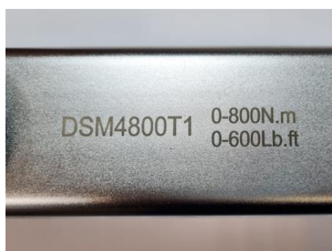
Рисунок 2 - Обозначения, наносимые на корпус ключей динамометрических DSM 4800T1: а) модификация, диапазон показаний; б) серийный номер.
