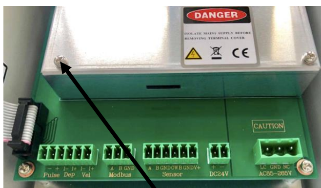
Рисунок 6-Место пломбирования электронного блока Расходомера-счетчика доплеровского ультразвукового Стримлюкс (Streamlux) модели SLD-850F
