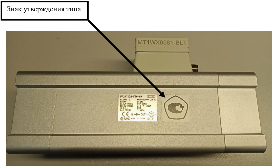
Рисунок 12 — Место нанесения знака утверждения типа
