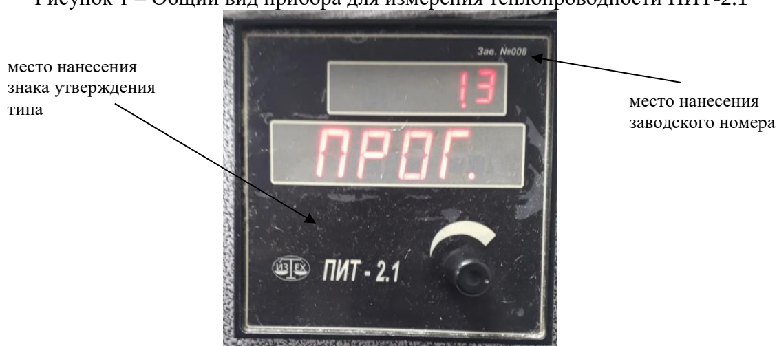
Рисунок 2 – Место нанесения знака утверждения типа и заводского номера
