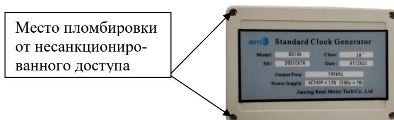
Рисунок4 –Места пломбировки генератора опорной частоты
