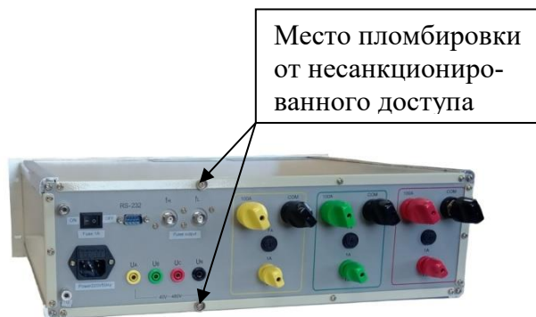
Рисунок2 –Места пломбировки блока измерений
