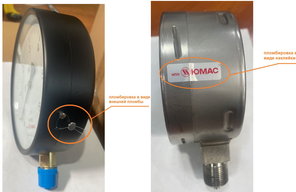
Рисунок 15 – Места установки пломбировки корпуса прибора
