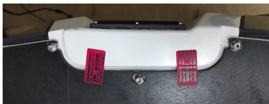
Рисунок 4 – Схема пломбировки от несанкционированного доступа
