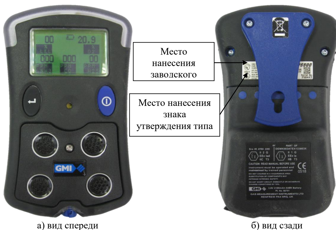
Рисунок 2 – Общий вид газоанализаторов PS500 с указанием места нанесения знака утверждения типа, места нанесения заводского номера
