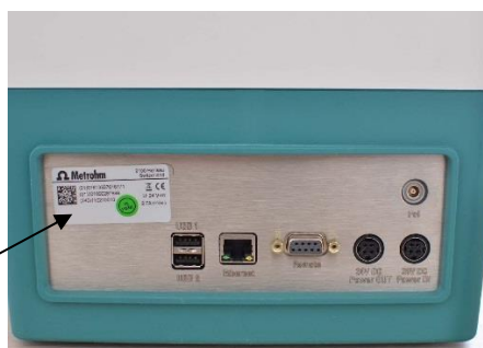
Рисунок 2 – Место размещения маркировочной таблички на задней панели титраторов Пломбирование титраторов не предусмотрено.
