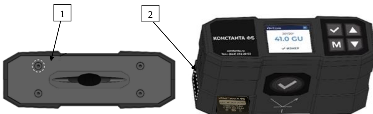
Рисунок 2 – Схема пломбирования приборов для измерения блеска и коэффициента яркости Константа ФБ 1 и/или 2 - Места пломбирования
