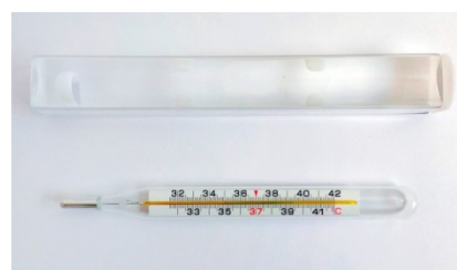
б) термометр с диапазоном измерений от +32 до +42 °С в футляре с увеличительной линзой
