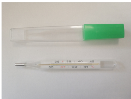
в) термометр с диапазоном измерений от +35 до +42 °С в пластмассовом футляре
