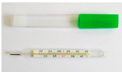
а) термометр с диапазоном измерений от +32 до +42 °С в пластмассовом футляре
