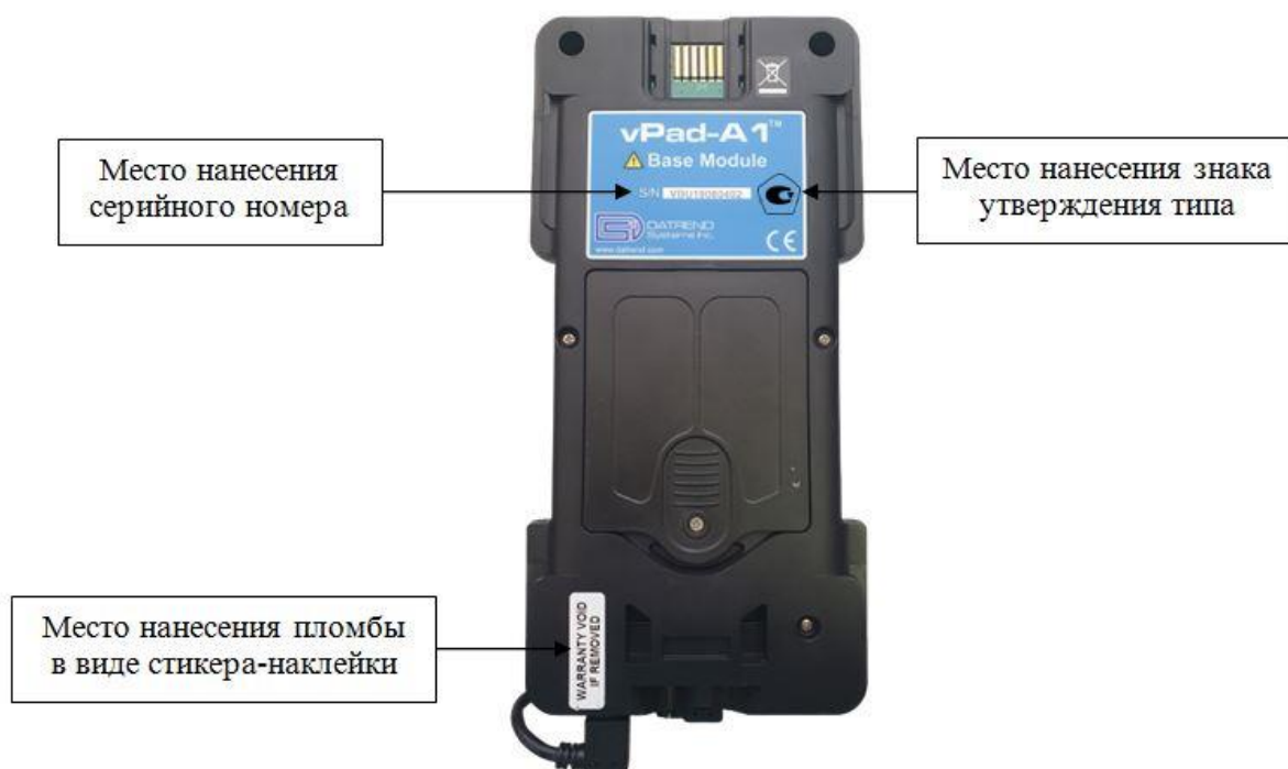
Рисунок 1 – Общий вид средства измерений с указанием места нанесения серийного номера, знака утверждения типа и места пломбирования
