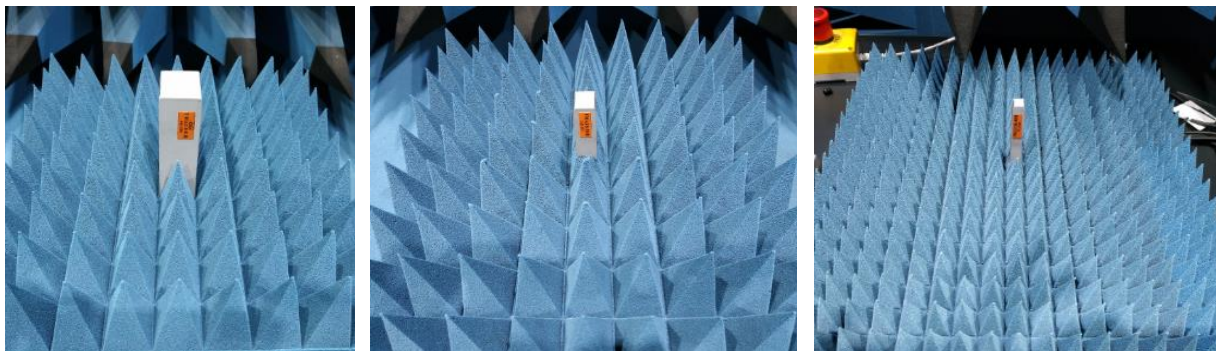
Рисунок 21 – Общий вид антенн-зондов диапазонов слева направо: от 4 до 8 ГГц; от 8 до 18 ГГц; от 18 до 40 ГГц
