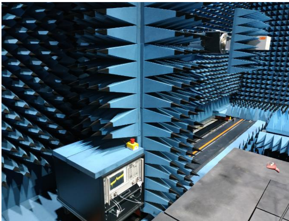
Рисунок 15 – Общий вид четырехкоординатного Т-сканера AL-4952-5м-5м-0.25м с установленным антенной-зондом, а также приборной стойки 12U
