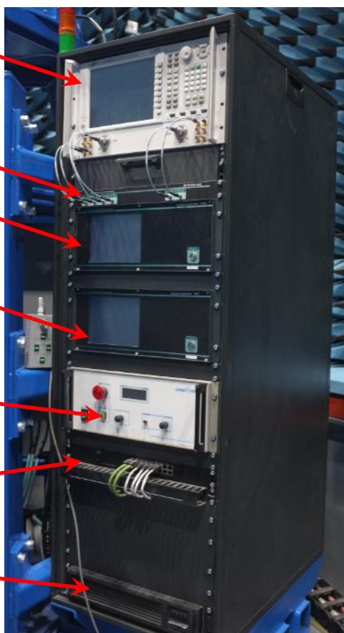
Рисунок 12 – Размещение оборудования в приборной стойке 34U
