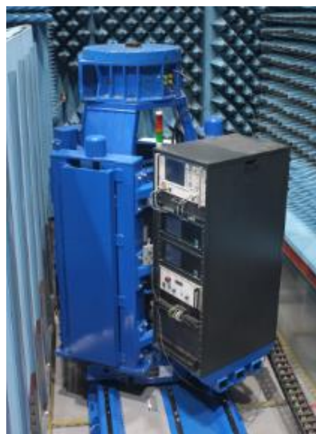
1 - слайдер AL-49140-1; 2 – подъемник; 3 – азимутальный позиционер AL-1760-1; 4 – приборная стойка; 5 – металлический шкаф для размещения электрооборудования Рисунок 5 – Общий вид прецизионного 5-ти координатного опорно-поворотного устройства
