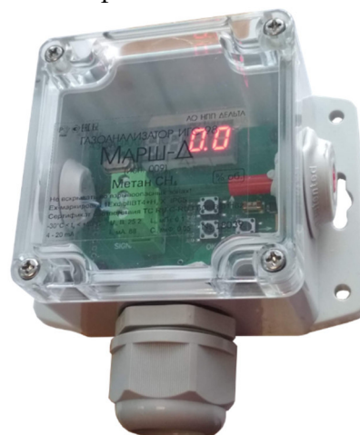
Рисунок 14 – Общий вид газоанализаторов ИГС-98 Модификации «Марш-Д» исп.009
