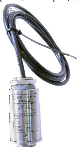
Рисунок 7 – Общий вид газоанализаторов ИГС-98 Модификации «Верба-Д» исп.014
