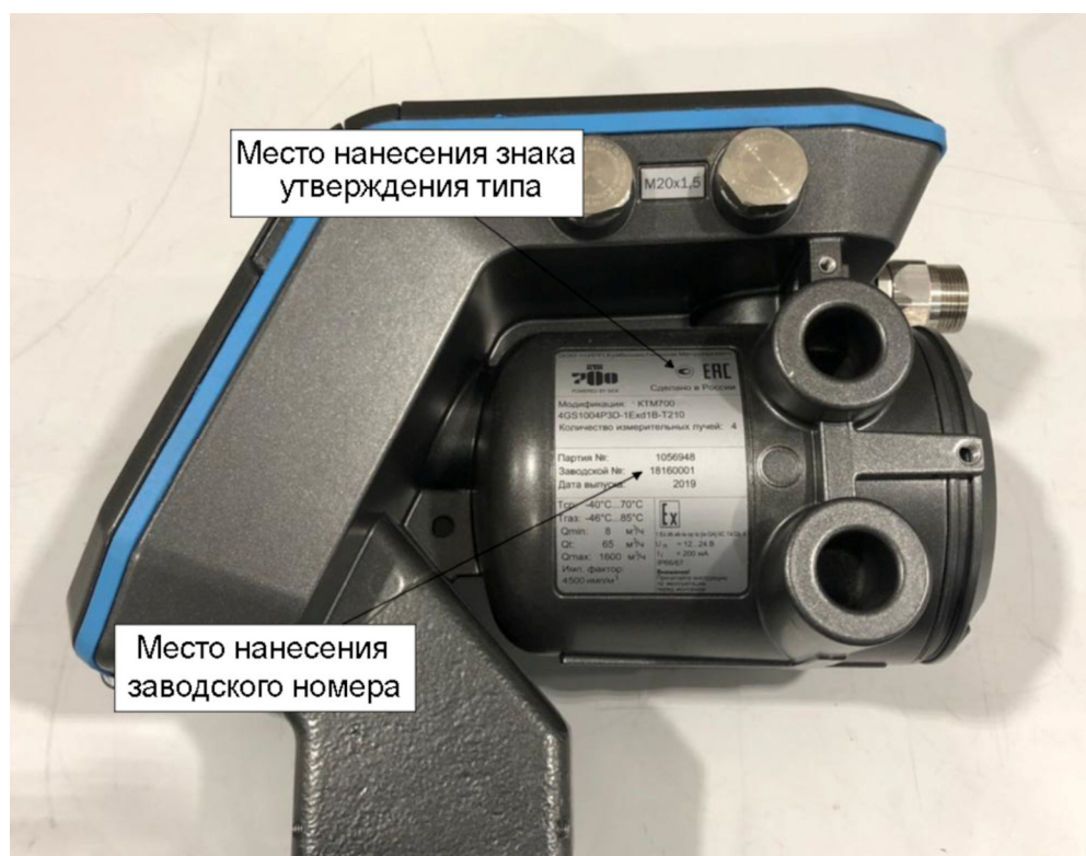
Рисунок 8 – Место нанесения заводского номера и знака утверждения типа счетчика модификаций КТМ700 РУС 4-лучевой, КТМ700 РУС Квадро, КТМ700 РУС Дуо и КТМ700 РУС Про
