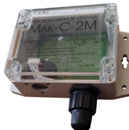
Рисунок 16 – Общий вид газоанализаторов ИГС-98 Модификации «Мак-С-2М» исп.026
