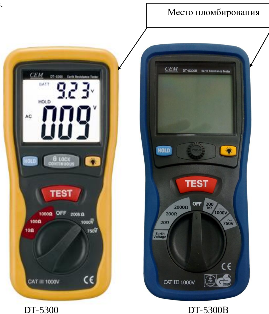
Общий вид измерителей сопротивления заземления DT-5300, DT-5300B
