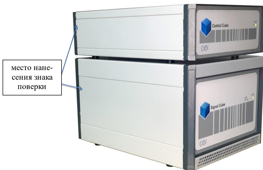
Рисунок 1 – Внешний вид комплексов измерительно-вычислительных и управляющих Control Cube и Signal Cube и знака поверки
