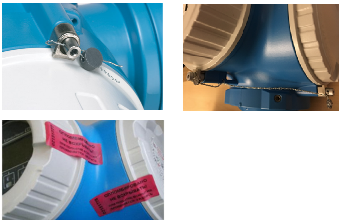
Рисунок 3 – Пломбирование корпуса измерительного преобразователя.
