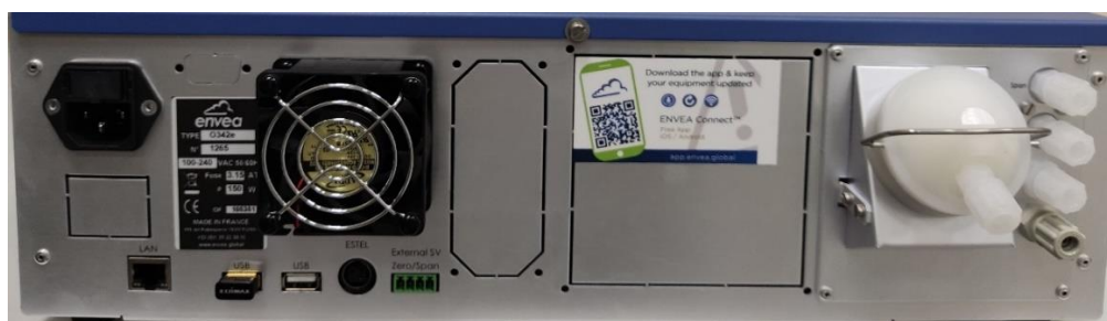
Рисунок 3 – Общий вид задней панели газоанализатора озона O342e
