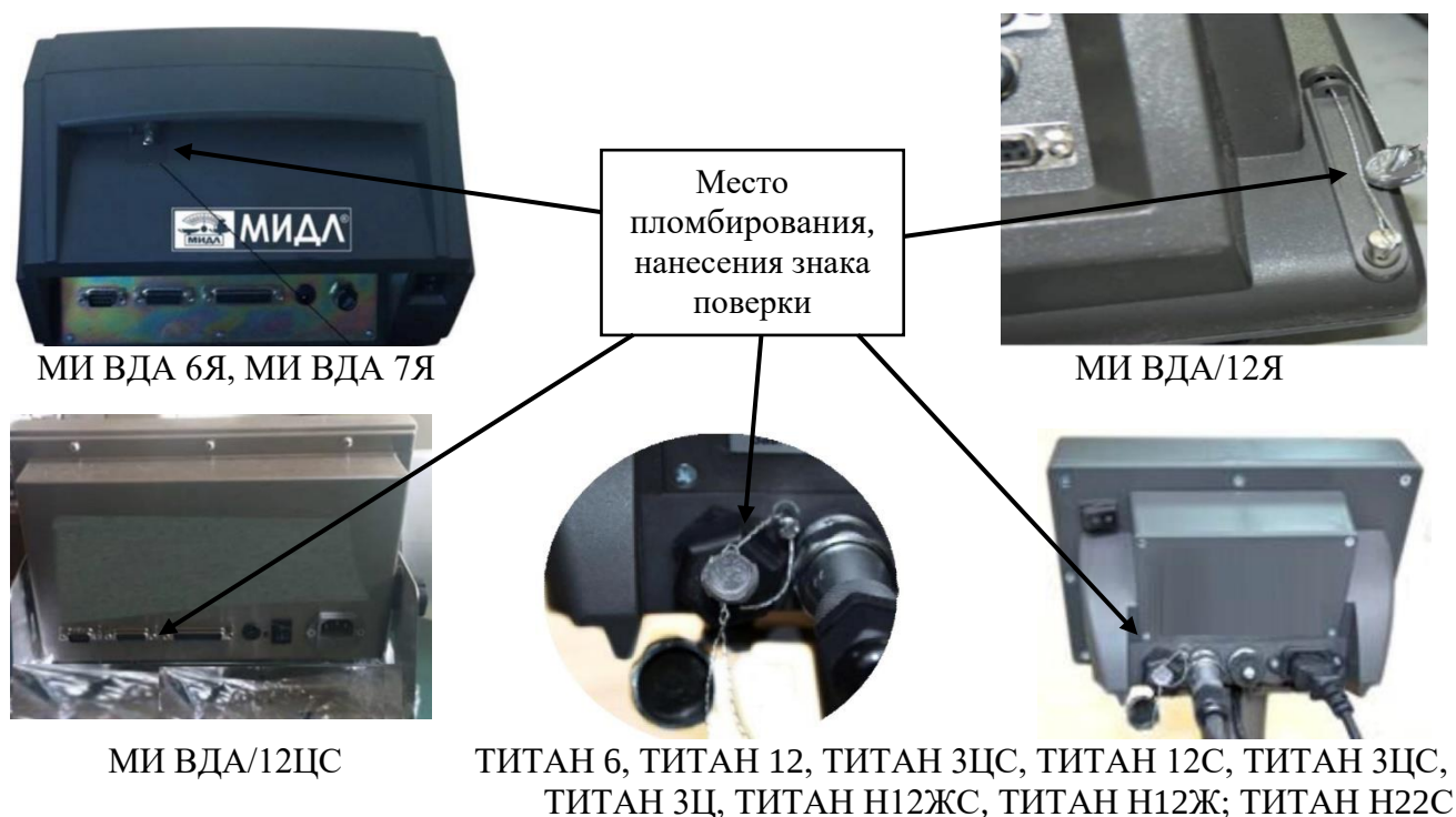
Рисунок 3 - Схема пломбировки от несанкционированного доступа, место нанесения знака поверки для весов автомобильных АСП
