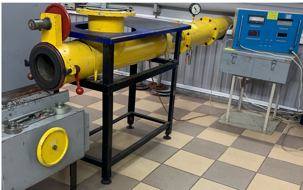
Рисунок 1 – Установка поверочная для счетчиков газа УПСГ-1600
