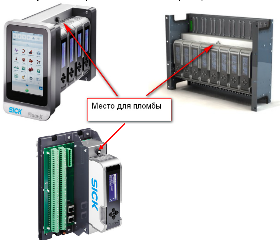
Рисунок 5а – Переключатель защиты параметров от записи.
