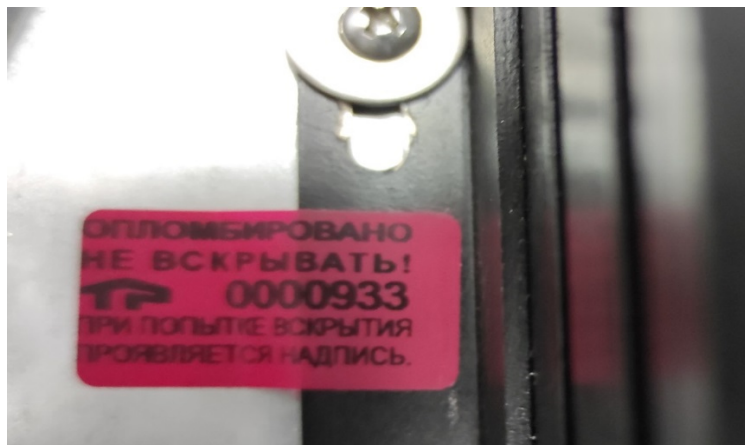
Рисунок 1 – Место пломбировки от несанкционированного доступа
