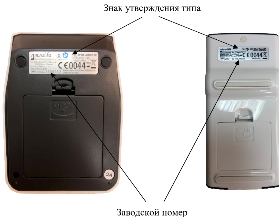
Рис. 12 – Места нанесения знака утверждения типа и заводского номера
