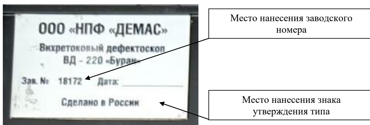
Рисунок 3 - Внешний вид маркировочной таблички дефектоскопов вихретоковых портативных ВД-220 «БУРАН» с указанием мест нанесения знака утверждения типа и заводского номера
