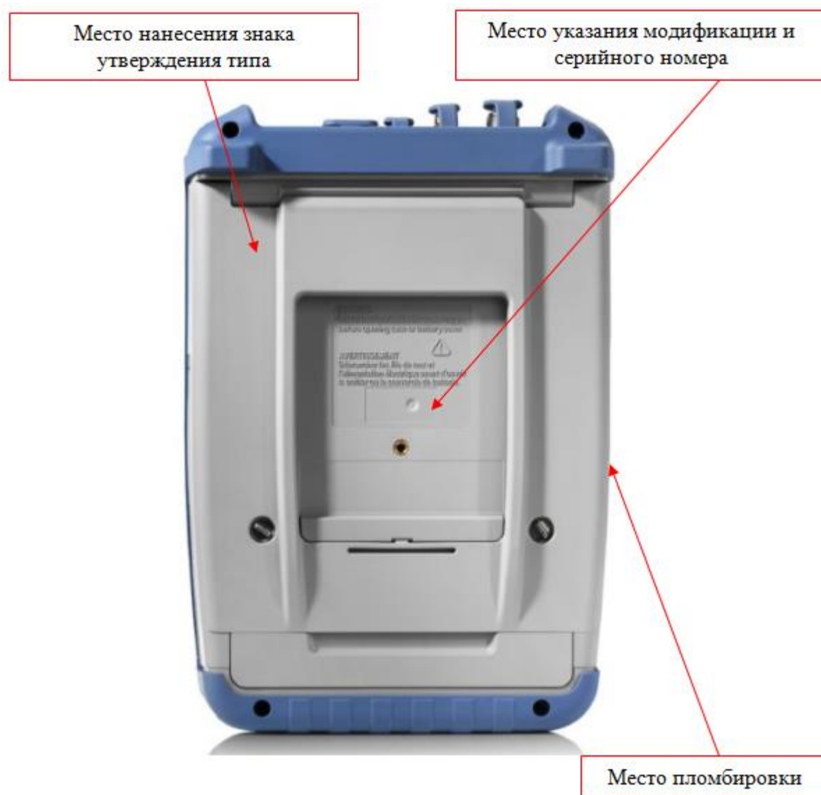
Рисунок 2 – Схема пломбировки от несанкционированного доступа и места нанесения серийного номера, идентифицирующего каждый экземпляр СИ, информации о модификации, а также знака утверждения типа
