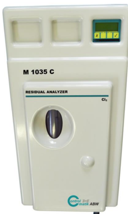
Рисунок 1 – Общий вид анализатора свободного хлора М 1035 С
