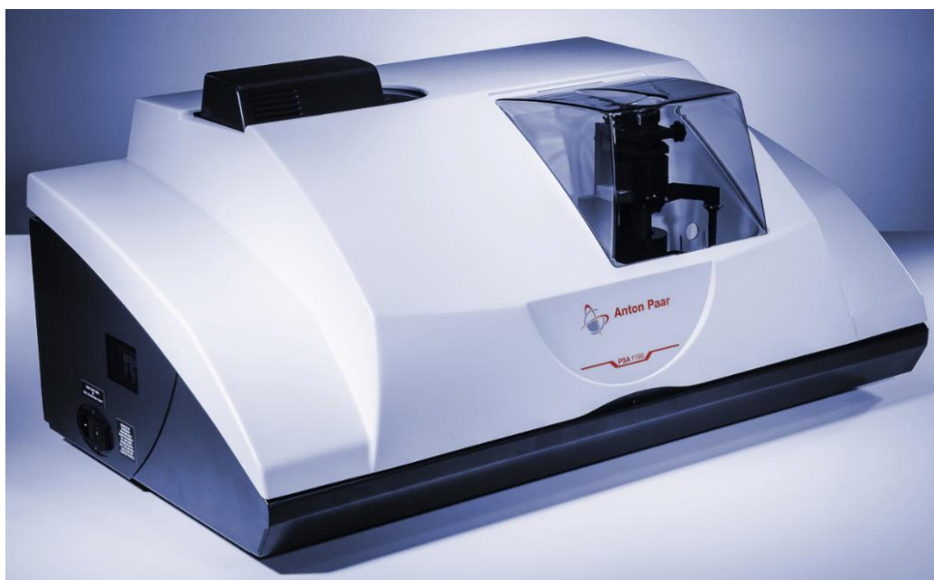
Рисунок 1 - Общий вид анализаторов размера частиц PSA
