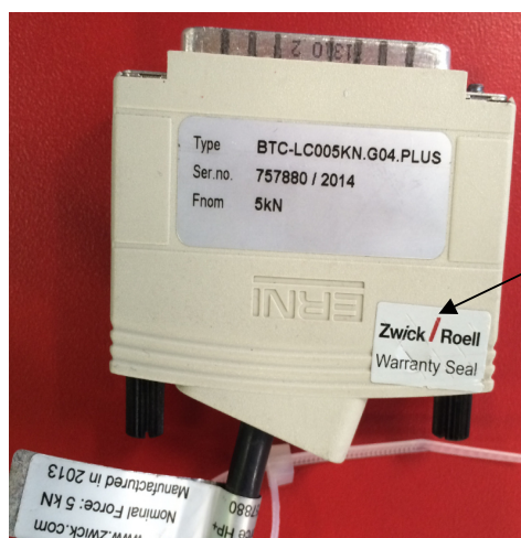
Рисунок 5 - Место нанесения пломбировки
