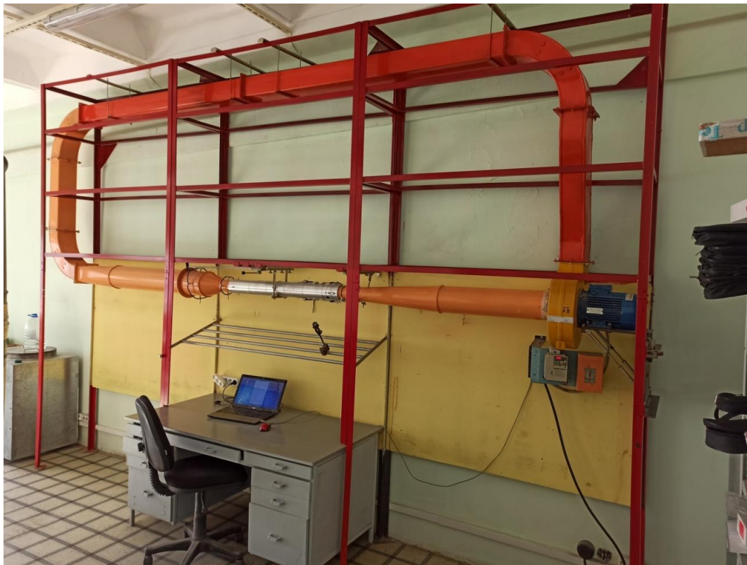
Рисунок 1 - Общий вид трубы аэродинамической АТМ-1
