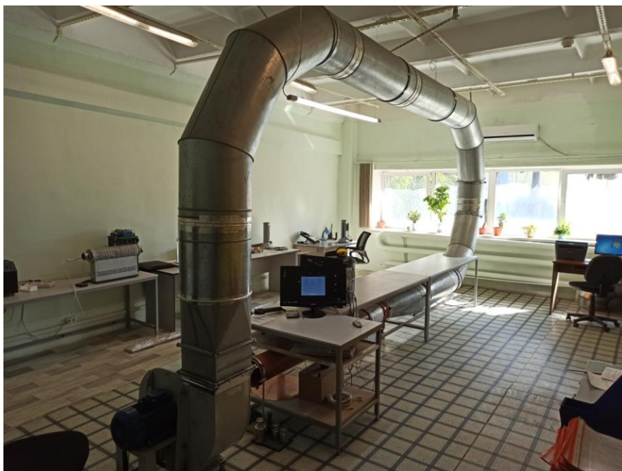
Рисунок 2 - Общий вид трубы аэродинамической АТБ-2
