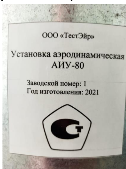
Рисунок 4 - Знак утверждения типа и заводской номер на шильдике
