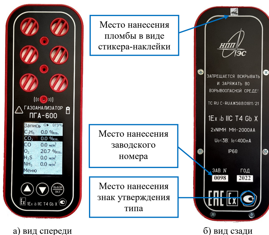
а) вид спереди б) вид сзади Рисунок 2 – Внешний вид газоанализаторов ПГА-600 (черно-красном корпусе)
