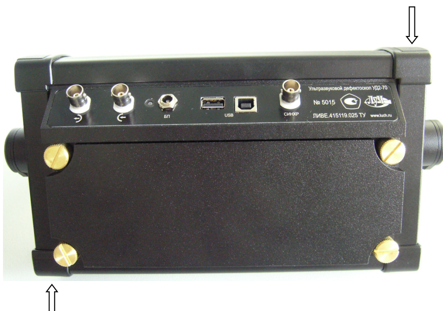
Рисунок 2а – Общий вид задней панели дефектоскопов ультразвуковых УД2-70 в металлическом корпусе и места нанесения пломбировки.
