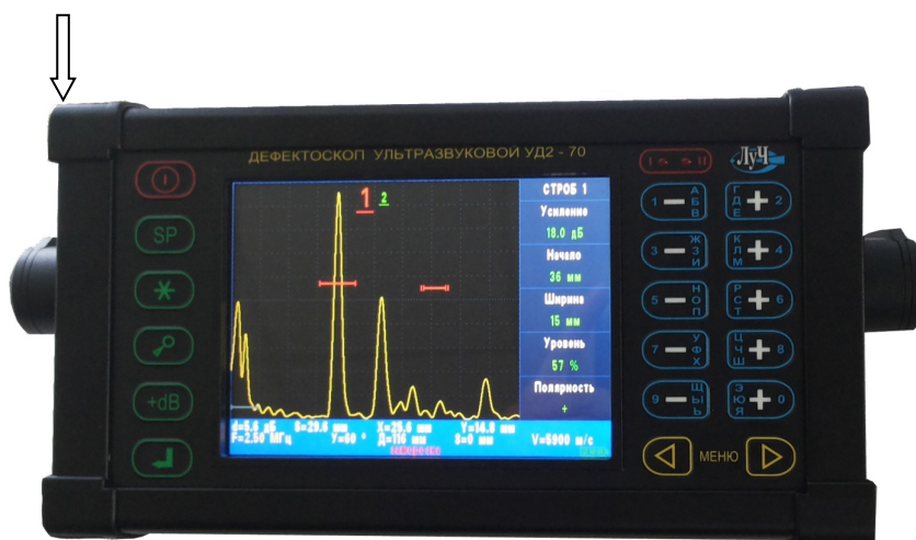
Рисунок 1а - общий вид дефектоскопов ультразвуковых УД2-70 в металлическом корпусе и места нанесения пломбировки.
