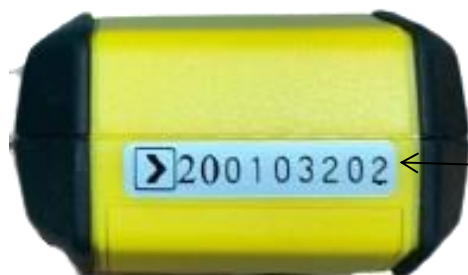
Рисунок 5 – Место нанесения заводского (серийного) номера анемометров модификаций BA06 и BA16
