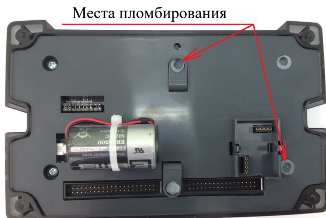
Рисунок 7 – Пломбирование тепловычислителя ВКТ-9
