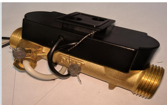
Знак поверки Наносится на свинцовую пломбу
