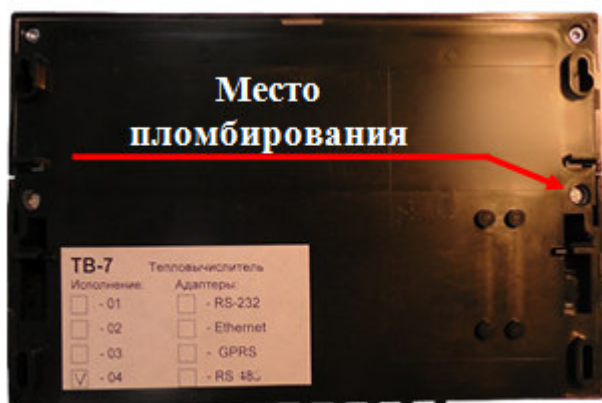
Рисунок 6 – Пломбирование тепловычислителя ТВ7
