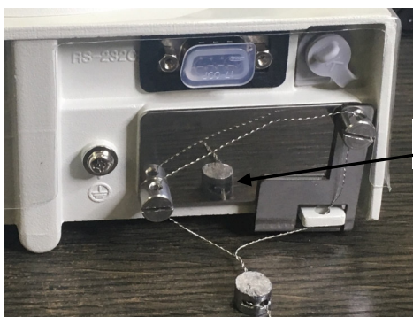
Рисунок 2 – Схема пломбировки от несанкционированного доступа, обозначение места нанесения знака поверки (1 – свинцовая или пластиковая пломба; 2 – пломба в виде разрушаемой наклейки)
