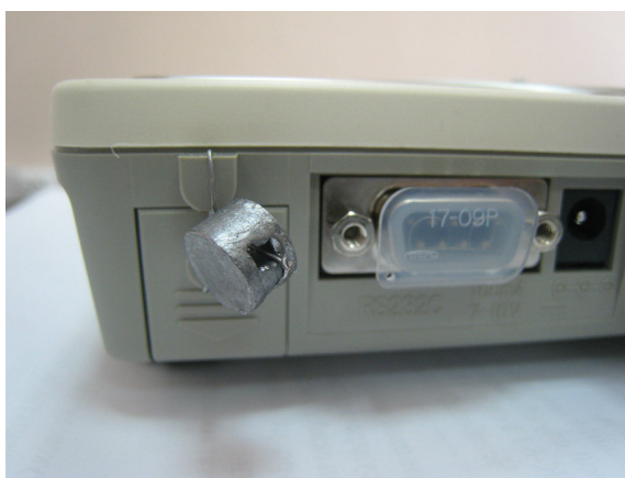
Рисунок 2 - Схема пломбировки от несанкционированного доступа
