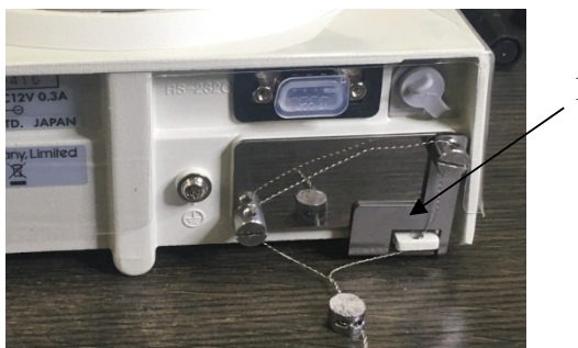
Рисунок 2 – Схема пломбировки от несанкционированного доступа, обозначение места нанесения знака поверки (1 – свинцовая или пластиковая пломба со знаком поверки в виде отиска поверительного клейма)
