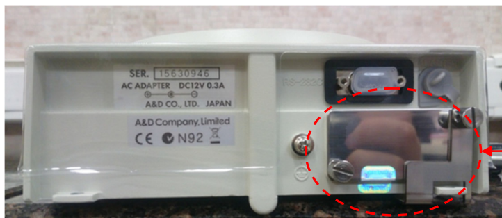
Рисунок 2 - Схема пломбировки весов от несанкционированного доступа
