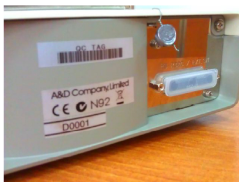
Рисунок 2 – Схема пломбировки весов от несанкционированного доступа
