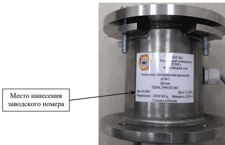
Рисунок 2 – Место нанесения заводского номера на электронный блок анализатора АСФ-1
