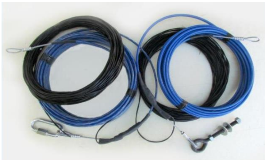
Рисунок 2 – Общий вид температурных кабелей
