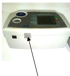
Рисунок 26 – Место нанесения защитной наклейки от несанкционированного доступа
