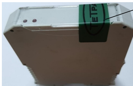
Рисунок 10 – Схема пломбировки от несанкционированного доступа
