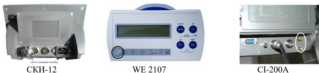
Рисунок 4 - Места пломбировки приборов (индикаторов) весоизмерительных
