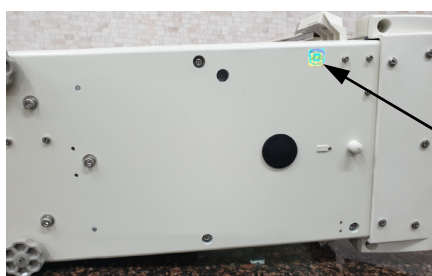
Рисунок 2 – Схема пломбирования весов от несанкционированного доступа
