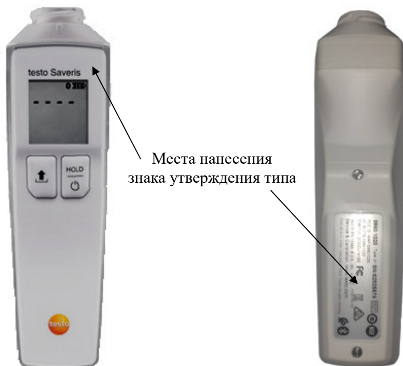
Рисунок 1 – Общий вид электронного блока Testo Saveris 0560 1020
