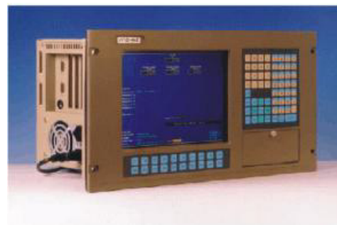
Рисунок 3 – Внешний вид промышленного компьютера UPC 500 P
