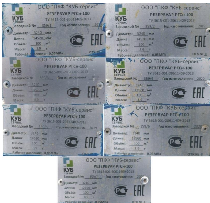
Рисунок 2 – Место нанесения заводских номеров резервуаров РГСН-100
