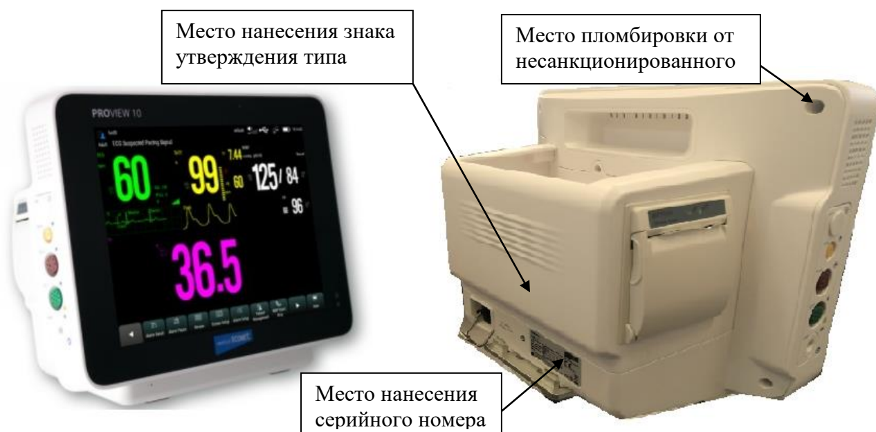
Рисунок 1 – Общий вид PROVIEW 10, схема пломбировки от несанкционированного доступа, место нанесения знака утверждения типа и место нанесения серийного номера
