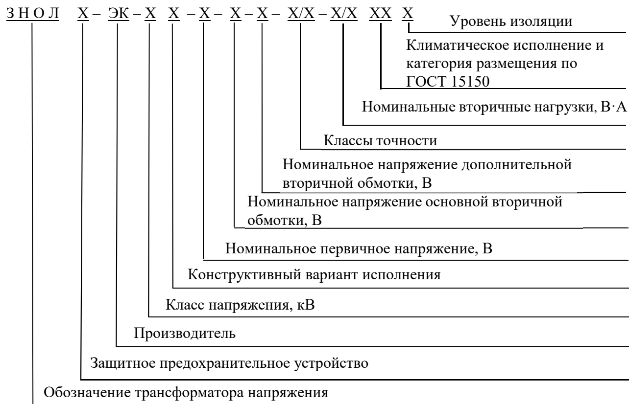
Рисунок 1 – Расшифровка условного обозначения трансформаторов напряжения
