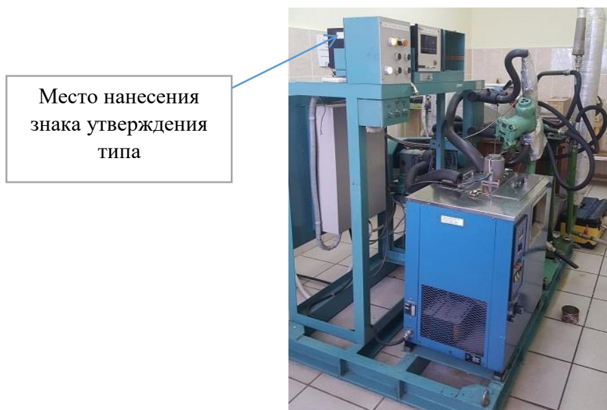
Рисунок 1 – Общий вид вискозиметра JSW в составе установки
