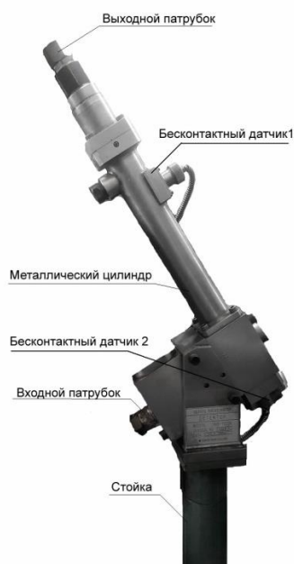
Рисунок 2 – Внешний вид вискозиметра JSW
