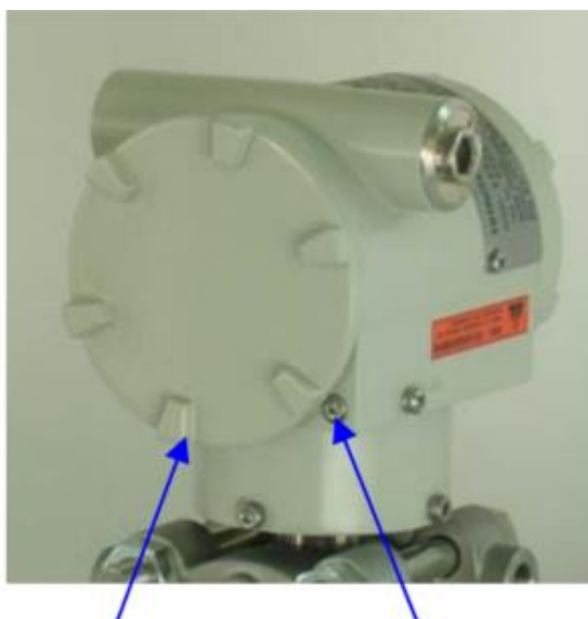
Рисунок 2 - Схема пломбировки от несанкционированного доступа преобразователя давления измерительного Hitachi EPR-N8S, зав.№№ 1118281
