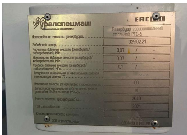
Рисунок 5 – Маркировочная табличка резервуара РГС-5 зав. № 029.02.21
