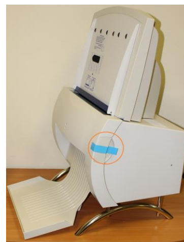
Рисунок 6 – Схема пломбировки сканера рентгеновских пленок
