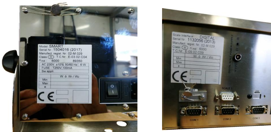
Рисунок 1 – Схема пломбировки индикаторов Smart и MATRIX II
