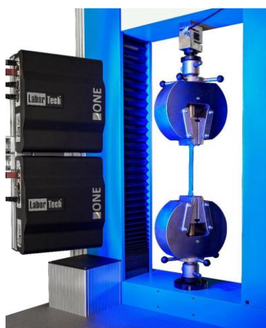
Рисунок 3 – Общий вид подключения двух измерителей
