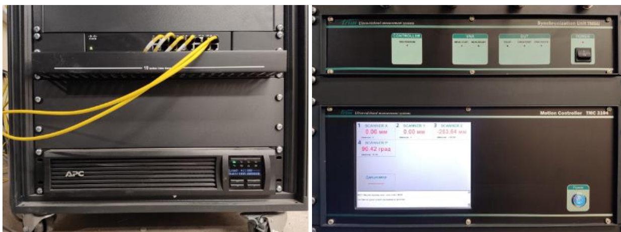
Рисунок 4 – Общий вид источника бесперебойного питания (слева), контроллера управления сканером и блока синхронизации (справа)
