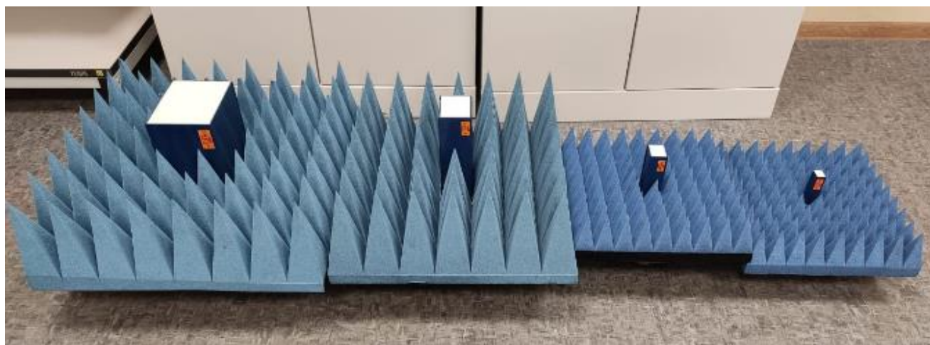
Рисунок 3 – Общий вид антенн-зондов диапазонов слева направо: от 1 до 2 ГГц; от 2 до 4 ГГц; от 4 до 8 ГГц; от 8 до 18 ГГц
