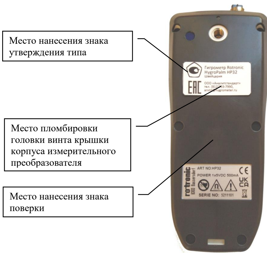
Рисунок 2 – Место нанесения знака поверки и пломбирования от несанкционированного доступа
