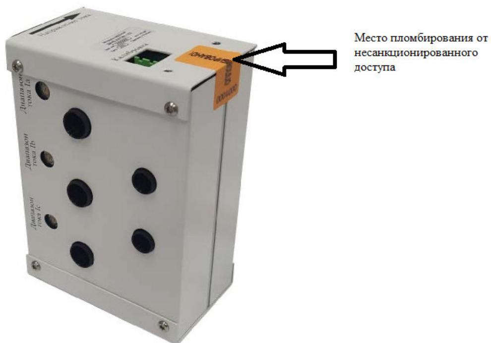
Рисунок 8 - Место пломбирования от несанкционированного доступа модуля МДТН-Н
