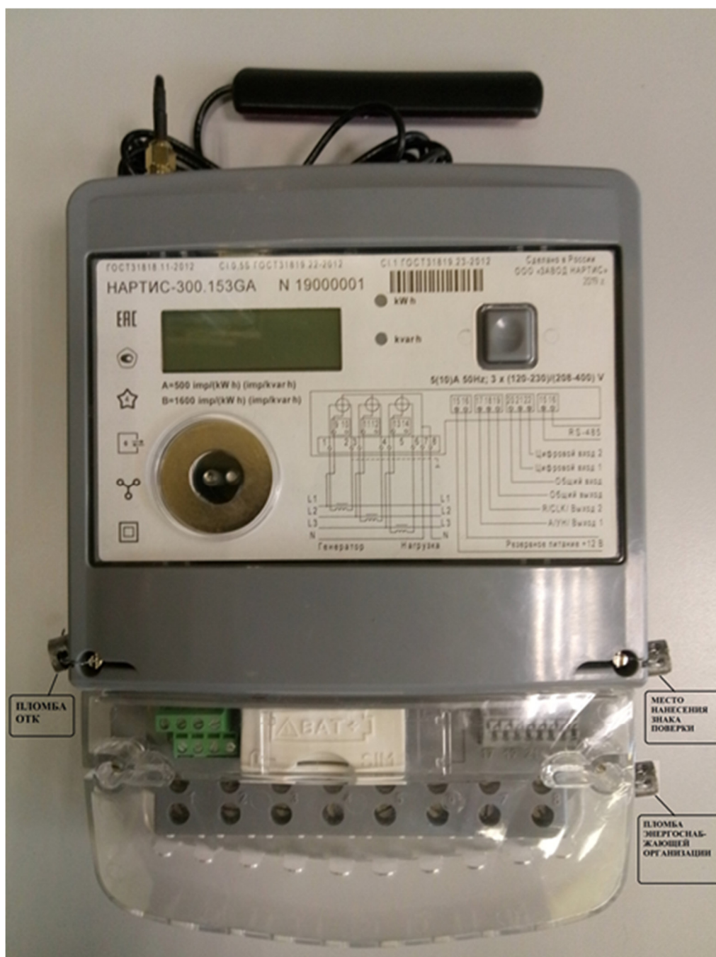
Рисунок 1 – Общий вид счетчика с внешней антенной, предназначенного для использования в закрытых помещениях, мест пломбировки, мест нанесения знака утверждения типа, знака поверки, заводского номера.
