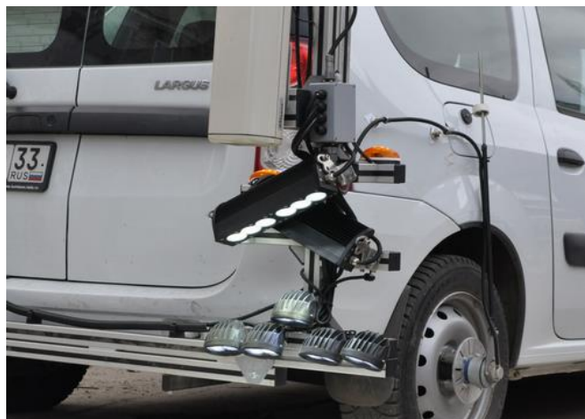
Рисунок 8 – Система контроля геометрических параметров дорожной разметки РДТ-820 канала «разметка»
