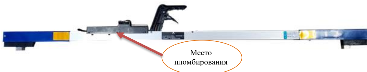
Рисунок 4 – Места пломбирования шаблонов ШП (указаны стрелкой).
