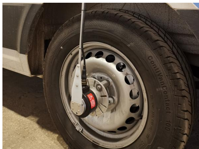
Рисунок 3 – Датчик пройденного пути РДТ-819 канала «путь В»
