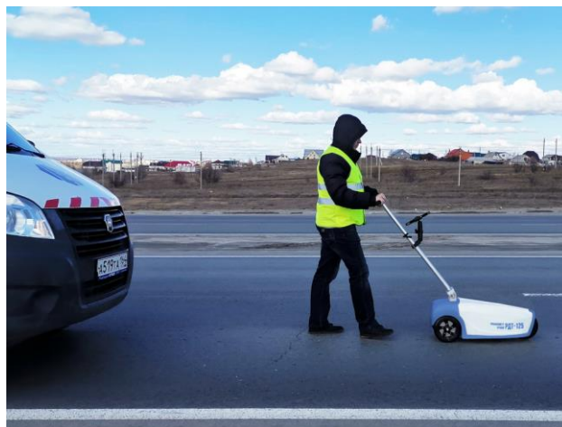
Рисунок 9 – Профилометр ручной РДТ-125 канала «ровность IRI»
