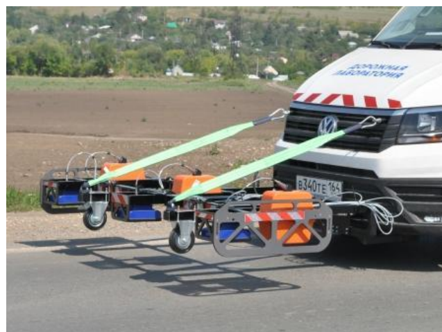
Рисунок 15 – Система подповерхностного зондирования РДТ-825/3х1700+2х1000+1х2200 канала «георадар» с шестью АБ
