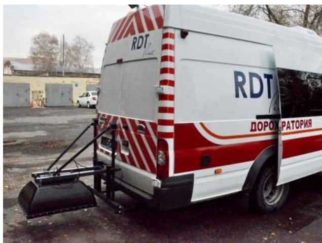
Рисунок 14 – Система подповерхностного зондирования РДТ-825/1х400 канала «георадар» с одним АБ
