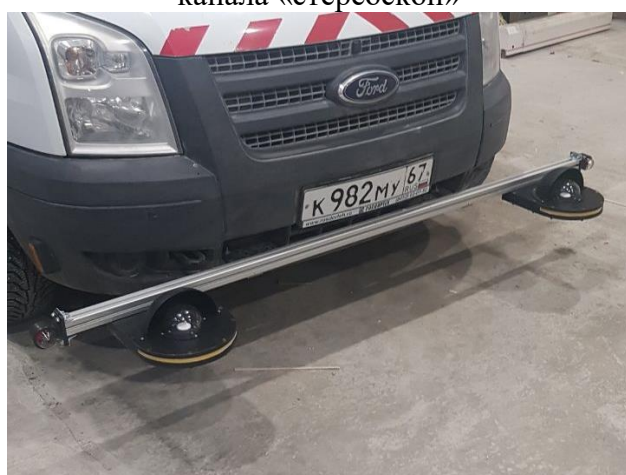
Рисунок 12 – Система контроля уровня освещенности дорожного покрытия РДТ-822 канала «освещенность»
