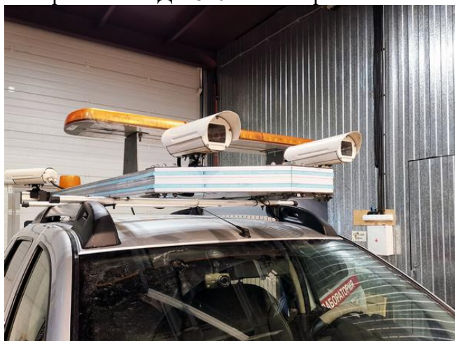
Рисунок 10 – Система стереовидеосъемки РДТ-817 канала «стереоскоп»
