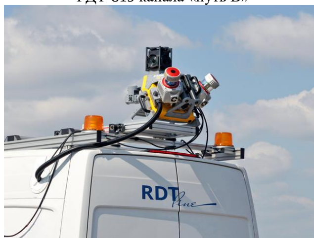
Рисунок 5 – Система мобильного картографирования Trimble MX9 канала «лидар»
