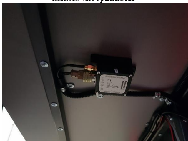
Рисунок 6 – Инерциальная навигационная система РДТ-816 канала «геометрия В»
