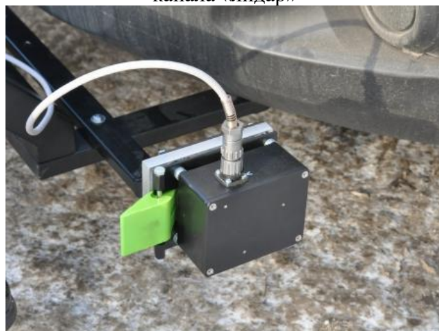
Рисунок 7 – Профилометр дорожный РДТ-818 канала «макросероховатость»
