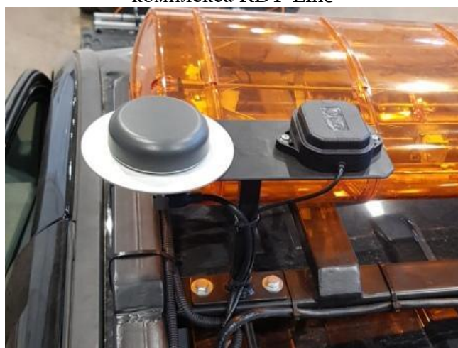
Рисунок 4 – Приёмные антенны аппаратуры геодезической спутниковой NV08C-RTK-M канала «координаты»
