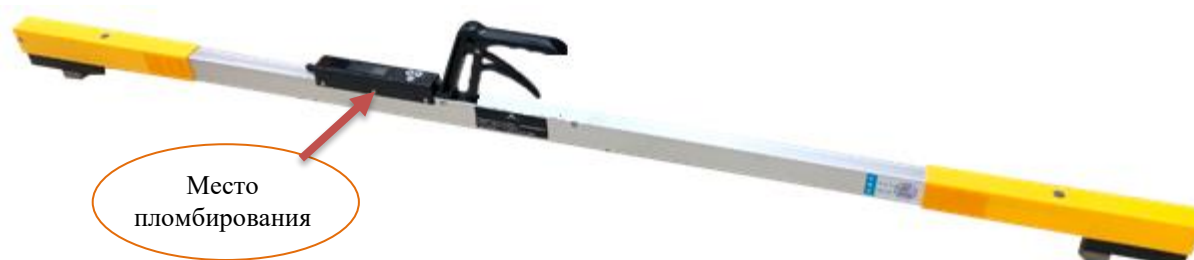
Рисунок 3 – Места пломбирования шаблонов ШПЭ (указаны стрелкой)
