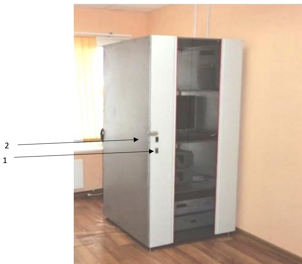
Рисунок 2 - Схема расположения замков на системе АМИИС-ЯМАЛ 1-замки на корпусе, 2-место нанесения знака утверждения типа
