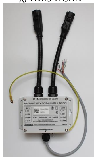
е) TKLS во взрывозащищенном исполнении с барьером искрозащиты TK.iSB
