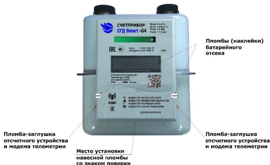
Рисунок 2 – Схема пломбировки счётчика от несанкционированного доступа
