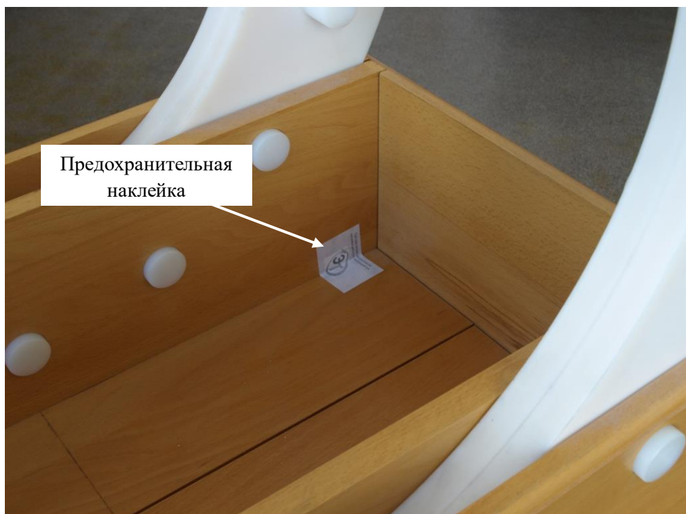
Рисунок 3 — УП-1000. Вид сверху. Схема пломбировки от несанкционированного доступа
